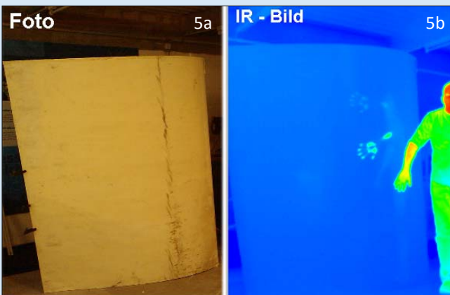
Fig. 5: Test piece (a) visible light (b) infrared with size comparison Fig. 5a: Visible light, heavy soiling, no direct damage detectable Fig. 5b: Thermographic picture: no detection visible without information of the blade interior Abb. 5: Teststück (a) sichtbar (b) infrarot mit Größenvergleich Abb. 5a: Optisch, starke Verschmutzung, keine direkten Beschädigungen erkennbar Abb. 5b: Thermographisch: keine Auffälligkeiten, ohne Kenntnis des Blattinneren
