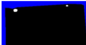
Abbildung 14: Automatisierte Auswertung der Prüfung. Die Risse sind im endgültigen Auswertebild als weisse Puknkte zu erkennen.
